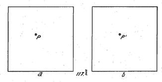
Fig. 117 - Corrispondenza tra i punti dell'immagine trasmessa e quelli dello schermo ricevente. a) immagine trasmessa - b) schermo ricevente.
