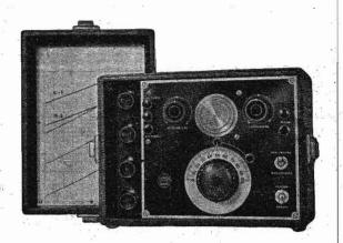
Cinque gamme d'onda: da 12 a 3000 m. - Bobine intercambiabili - Schermatura perfetta a mezzo fusioni in alluminio - Pannello di grande spessore inossidabile - Indice a molla - Modulazione interna ed esterna - Curve tracciate a mano per ogni apparecchio - Possibilità di avere qualsiasi altra bobina per altre gamme.
