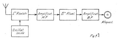
cuiti oscillatori accordati tutti ad una frequenza esterna alla banda che si vuole ricevere (di solito inferiore) ma comunque notevolmente più alta delle frequenze acustiche.
