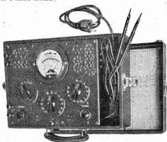
L'istrumento possiamo fornirlo a 1000 Ohmiper Volt come a 10.000, a 20.000 e anche più.
