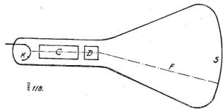
Fig. 118 · Schema di un tubo a raggi catodici per televisione K= catodo emittente · C= acceleratore e concentratore del fascio elettronico · D= sistema deviatore · F= fascio elettronico · S= schermo.
